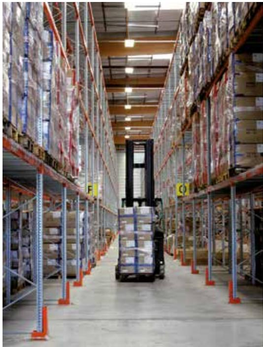
**INFO** HAUTEUR NÉCESSAIRE : il faut tenir compte de la hauteur de vos palettes chargées et d'un espace de manutention pour déterminer la hauteur totale de votre bâtiment. N'oubliez pas entre chaque niveau d'incorporer la hauteur du longeron et de tenir compte au réglage des longerons au pas de 75 mm.
