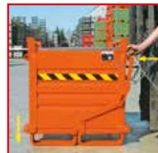
Verrouillage de la benne par poignée.
