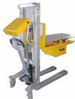
Gerbeur avec plateau rotatif indexé pour changement d'outils sur presse. Tirage à outils et coffre pour PC portable.
