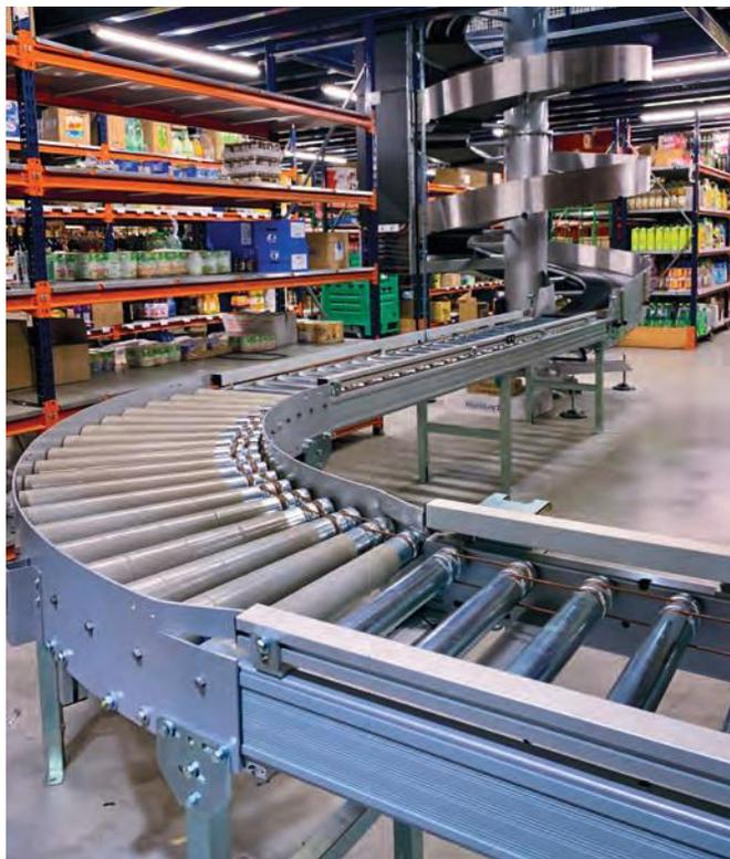
DDZZ0108: Convoyeur spirale et convoyeur rouleaux
