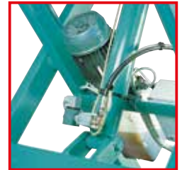
Descente stoppée en cas de rupture tubes hydrauliques
