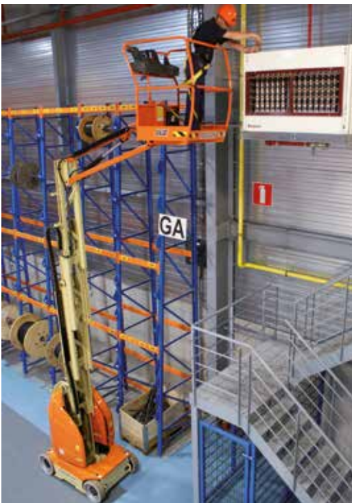
Les nacelles DDCE0616 et DDCE0617 sont équipées d'un panier rotatif.
