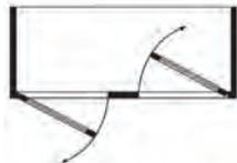
Positionnement des paumelles du bloc porte sur montant d'angle.
