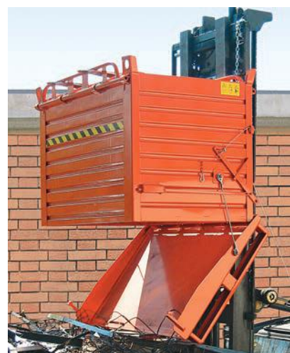
Verrouillage de la benne par poignée.
