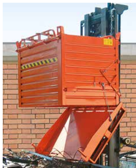
Verrouillage de la benne par poignée.
