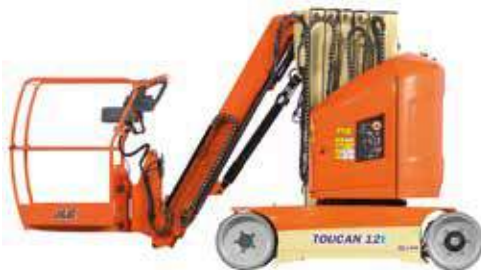
Avec sa hauteur repliée de 1,99 m, elle passe toutes les portes standards.
