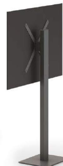
+ **Stand écran** sur socle robuste, peut recevoir un écran plat compatible norme « VESA » 200, 300 et 400, jusqu'à 42 pouces (106 cm) et 14 kg
