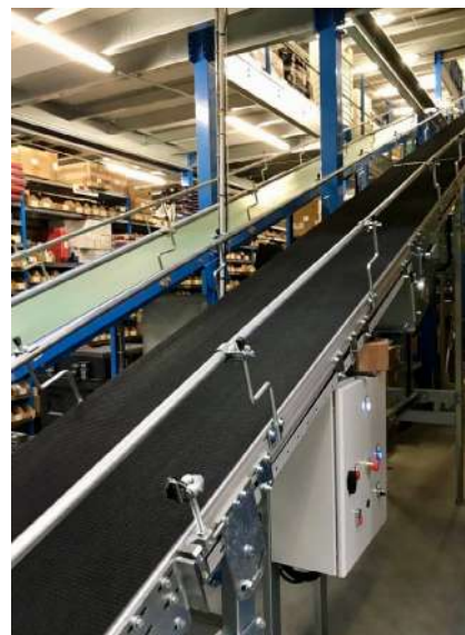
DDZZ0057 : Transporteur à bande pour charge jusqu'à 120 kg/m.
