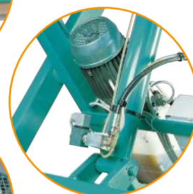
BLOCAGE AUTOMATIQUE Descente stoppée en cas de rupture tubes hydrauliques
