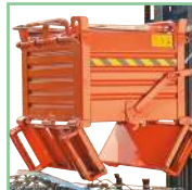
Vidage de la benne depuis le chariot élévateur.
