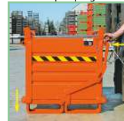
Verrouillage de la benne par poignée.
